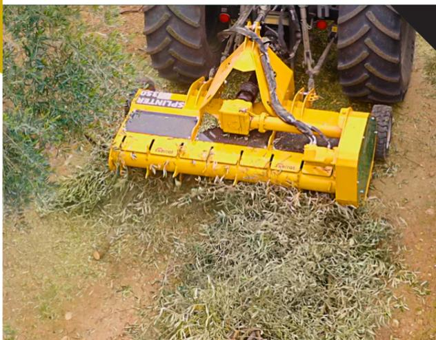
O triturador com alimentador hidráulico duplo, ideal para azeitonas, frutas cítricas e secas, mantém até 60 mm de diâmetro, com o rotor SERRAT SPLINTER para tratores entre 60 e 120 CV.
